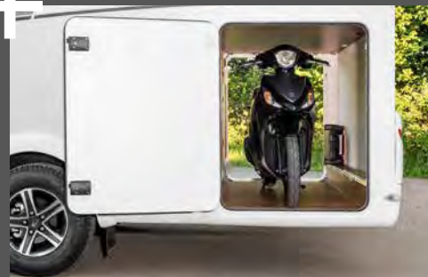
Garagerne i bag i enkeltsejersmodellerne er særligt høje og kan læsses fra begge sider gennem servicelugerne i venstre og højre side
